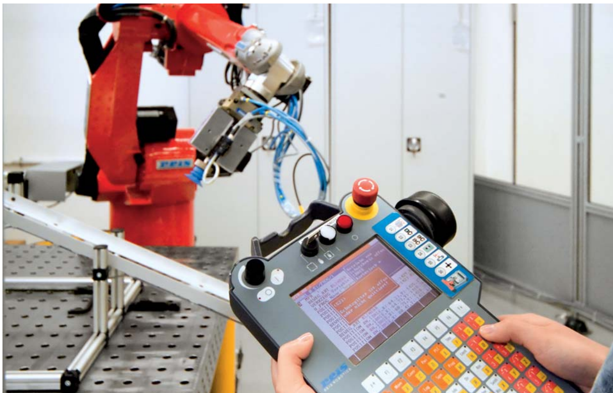
Roboter mit Programmierhandgerät im Labor der Hochschule Aschaffenburg
